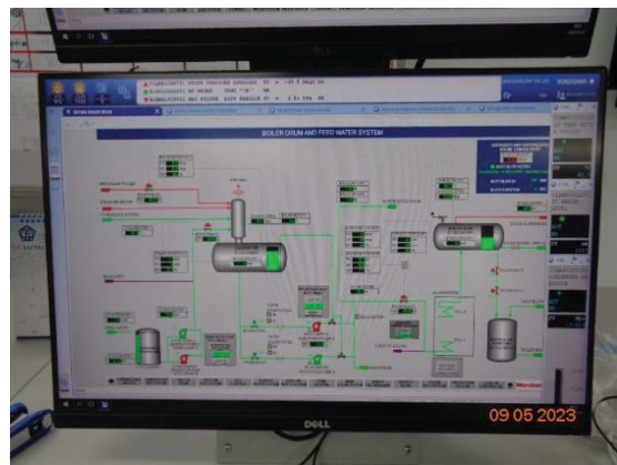
รูปที่ 80 หน้าจอ DCS แสดงการทำงานของหม้อไอน้ำ
